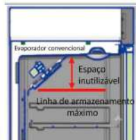
Duto de ar convencional
